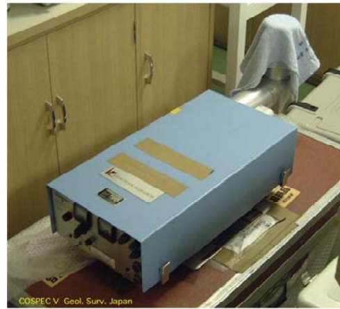
写真15 コスペック観測機材 布がかけられている部分が集光部分 (三宅島空撮 2002年2月6日：東宮)
